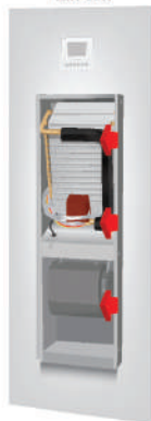
Step 3 Remove existing fan coil
